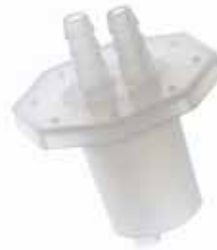
32502 Tapón polipropileno con dos olivas Con dos olivas para conexión de tubos de Øint 8 mm. Para uso con matraces esmerilados 29/32, ver ref. 23190-3.
