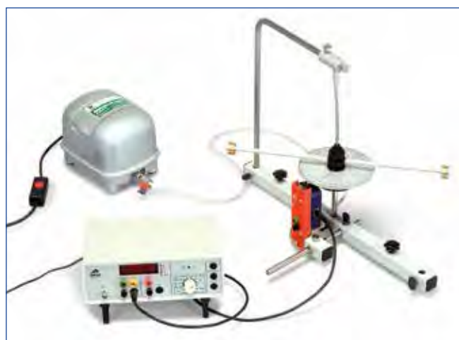
Medición de la duración del período y determinación del momento de inercia
