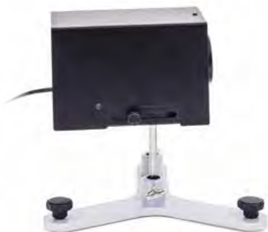
Montaje experimental para la irradiación del tubo de fluorescencia del sodio con luz blanca focalizada
