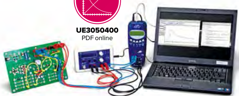
Registro de la curva de resonancia de un circuito oscilante RLC en serie
