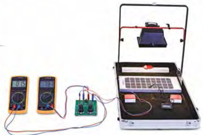
Dependencia de la temperatura de la potencia de módulos solares
