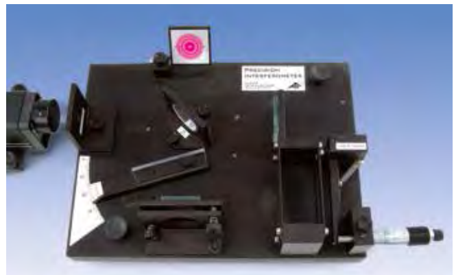
Placa de vidrio en la trayectoria del haz del interferómetro de Michelson
