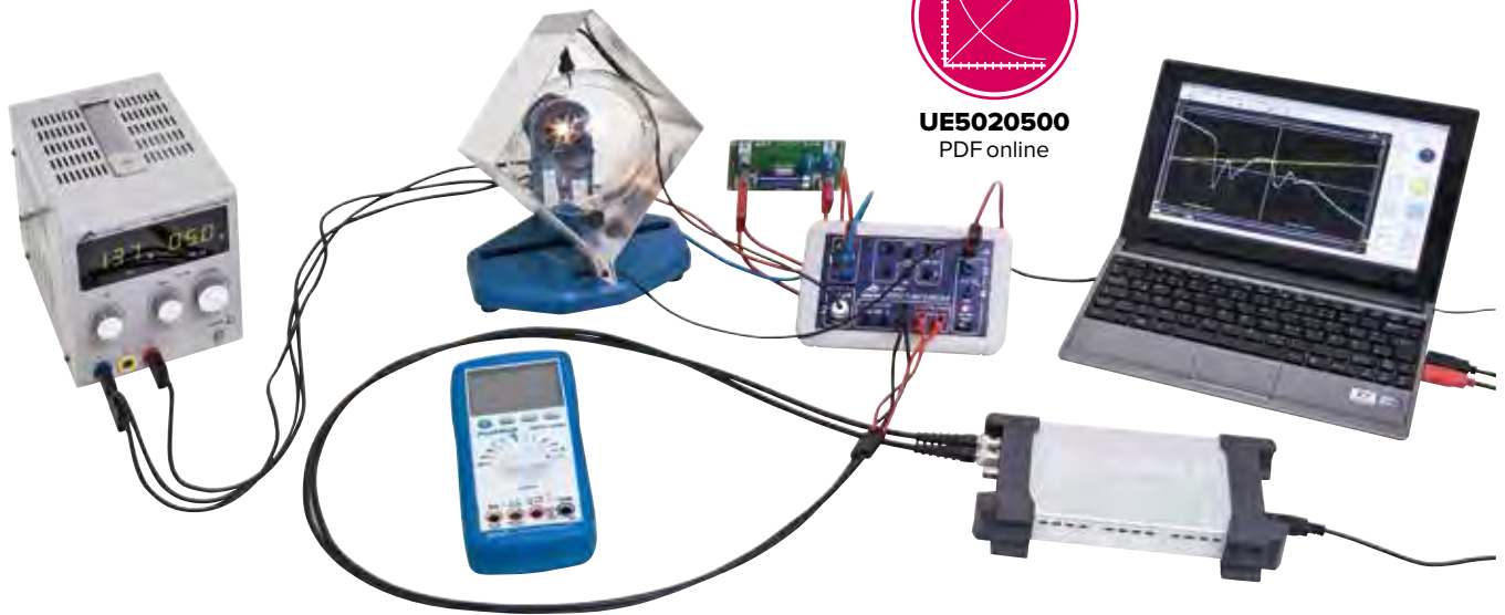
Montaje experimental con la unidad de control para tubos de potenciales críticos
