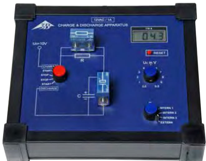
Medición en un par de RC externo
