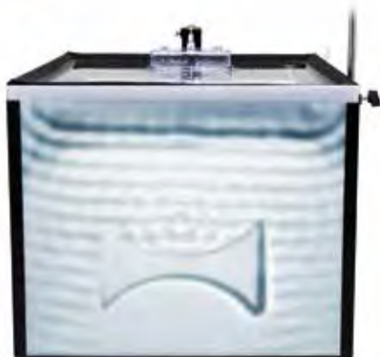
Reflexión de ondas de agua en un espejo cóncavo
