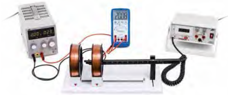
Medición del campo magnético de un par de bobinas con distancia variable
