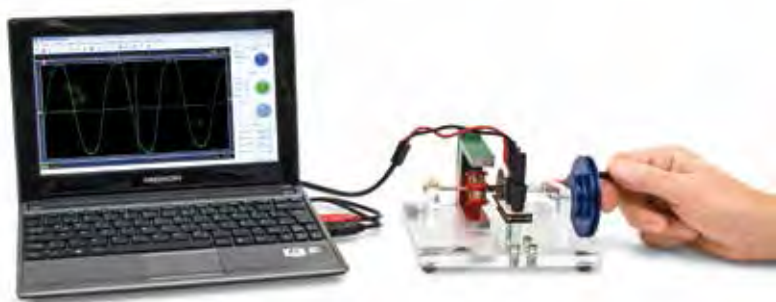
Funcionamiento como generador de CA
