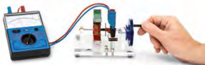
Funcionamiento como generador de CC
