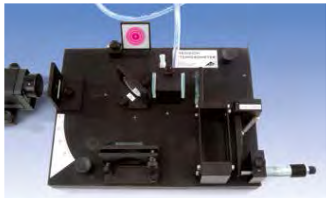
Celda al vacío en la trayectoria del haz del interferómetro de Michelson
