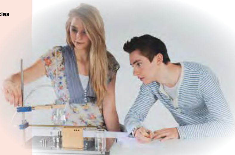
Variación de la longitud de sólidos al calentamiento
