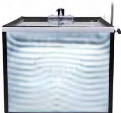
Refracción de ondas de agua sobre una lente convergente
