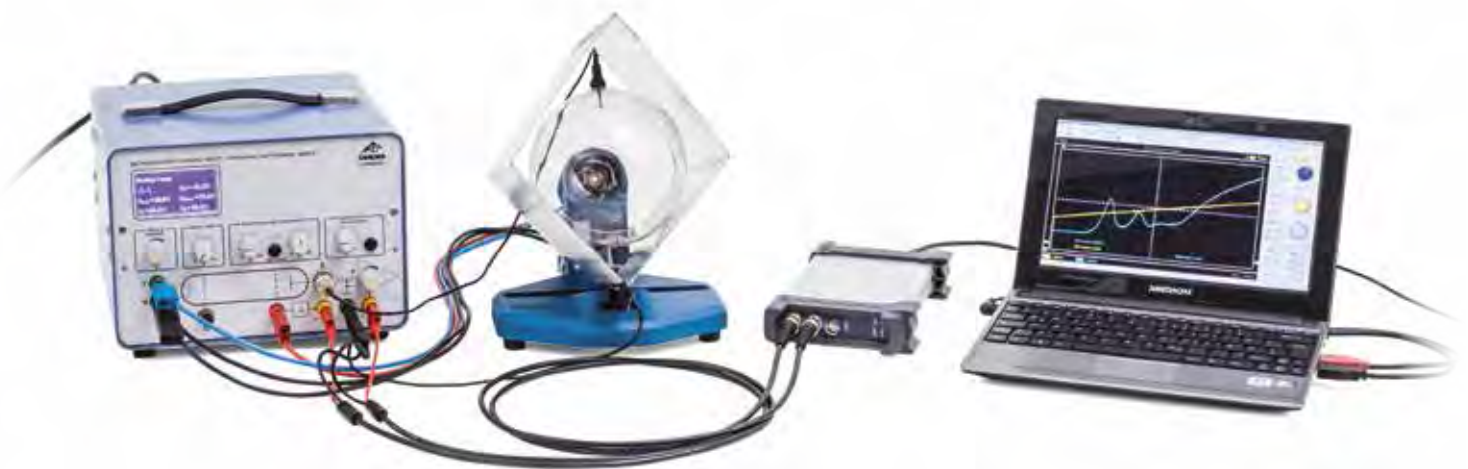
Montaje de experimentación con el aparato de operación para el experimento de Franck-Hertz
